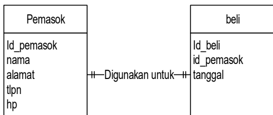
Gambar 3.3 Transformasi Kedua Diagram Entity Relationship (ERD)
