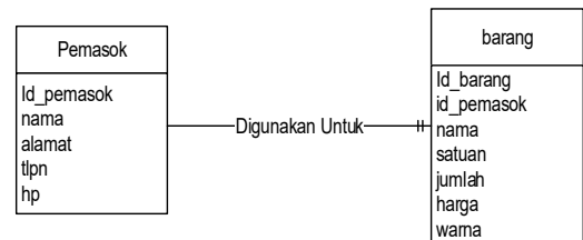
Gambar 3.5 Transformasi Keempat Diagram Entity Relationship
