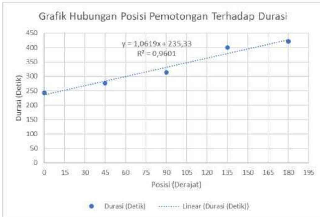
Gambar 3. Grafik Regresi Linear Rata-Rata Durasi Sudut Posisi Pemotongan Pelat
